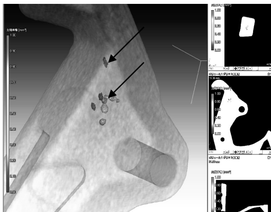
X線CT観察による樹脂製部品中のボイド
