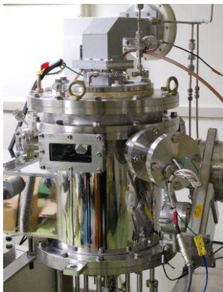
ラズマによって有機材料のエッチング（微細な穴を掘る）、様々な素材のクリーニングやアッシング（有機物の除去）、酸化、還元、窒化等が行えます。
