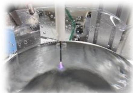
溶液表面にプラズマを照射します
