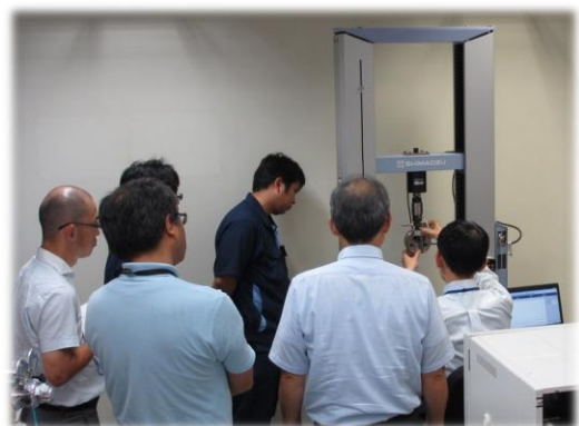
第 41 回 PLAM 実習<できるシリーズ> 引張試験機での接着強度測定の様子
