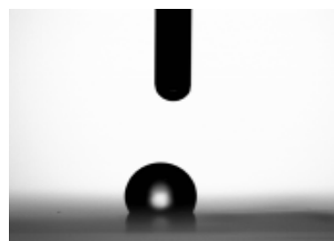
写真②撥水処理 接触角：118 度
