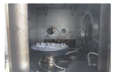
図 1-2 プラズマ処理容器の内部写真
