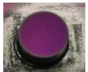
写真2：WC 基材上に cBN 膜を成膜した例
