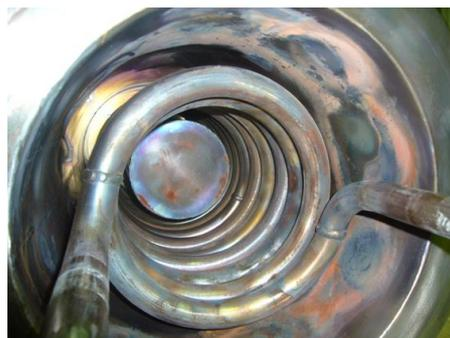
図7 二重螺旋構造蒸気配管
