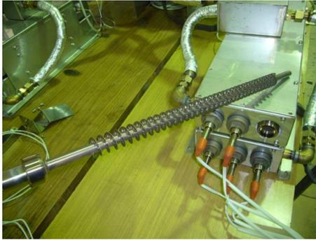
図10 フィン付電気ヒータ
