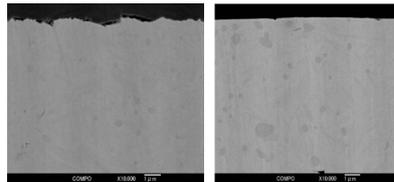
他社除錆剤処理後の金属 (SKD材) 断面      KC-12処理後の金属 (SKD材) 断面
