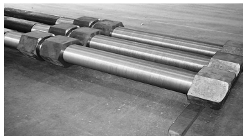
鋼製橋脚アンカーボルト
