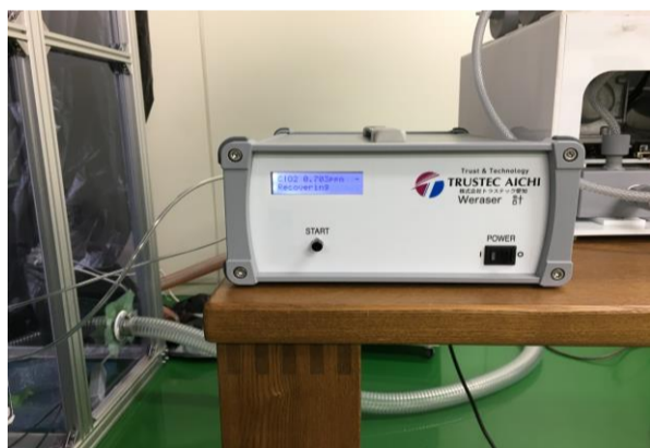
二酸化塩素ガスを測定中のWeraser計
