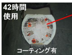
図 鑄造業界向け取鍋蓋用コーティング材 (耐熱性・遮熱性・強度向上)
