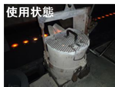
図 鑄造業界向け取鍋蓋用コーティング材 (耐熱性・遮熱性・強度向上)
